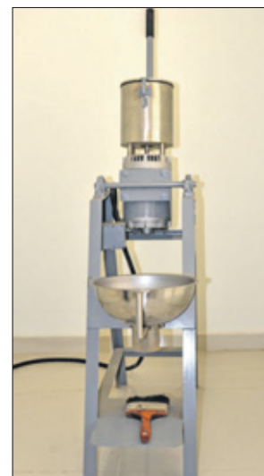
Het maalapparaat, dat de overgebleven stukjes bot helemaal fijnmaakt tot as.
