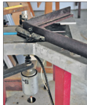
Met dit belangrijke apparaat worden de hoeken precies aan elkaar gesneden.
